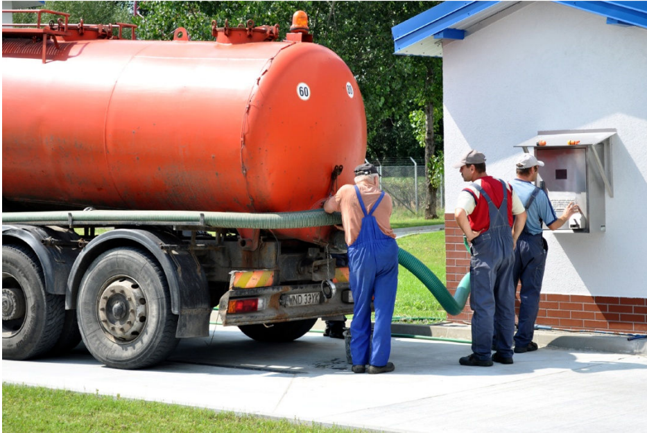
Zrzut ścieku z taboru asenizacyjnego do punktu zlewnego
